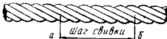
Рис. 1 - Определение шага свивки каната
