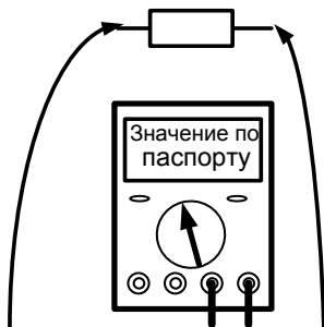
Рисунок 5–Схема проверки резистора с помощью мультиметра.
