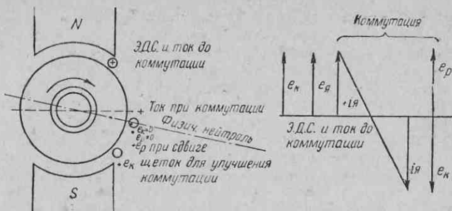
Рис. 33. Улучшение коммутации сдвигом щеток с физической нейтральной.
